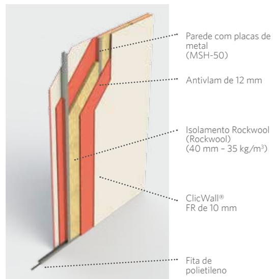
Antivlam relativamente a parede com placas de metal: parafuso para madeira, 4 x 25
