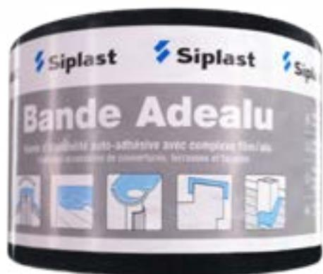
Banda de betún elastómetro SBS, de 1,5 Kg/m<sup>2</sup> de masa media, autoadhesiva en su cara inferior y recubierta de una hoja de aluminio de 5/100 mm de espesor en su cara superior.
