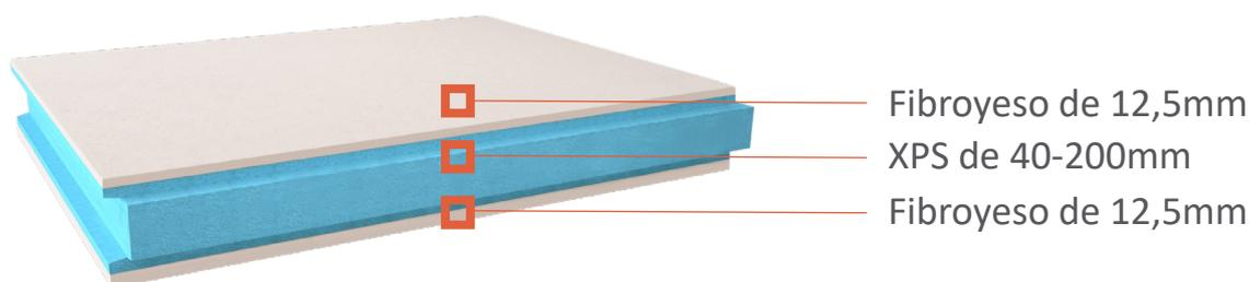
Panel para elementos interiores sin contacto con el exterior: suelos (FLOOR), trasdosados y tabiques (WALL). Es un panel simétrico con disposición libre.
