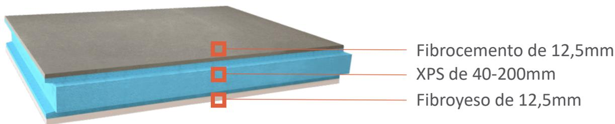
Panel para la envolvente exterior: fachadas (SATE), cubiertas (ROOF) y suelos en contacto con el exterior (FLOOR-S). Su disposición se hará siempre dejando el fibrocemento hacia el exterior.
